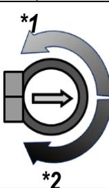
Le réglage le plus sensible (dans le sens des aiguilles d'une montre à droite, jusqu'à l'arrêt de Pos. \* 2) peut dans certains cas se fermer "trop tard" au crépuscule ou ne se ferme pas du tout. (Raison: éclairage à l'arrière-cour, usine à proximité, ...).
